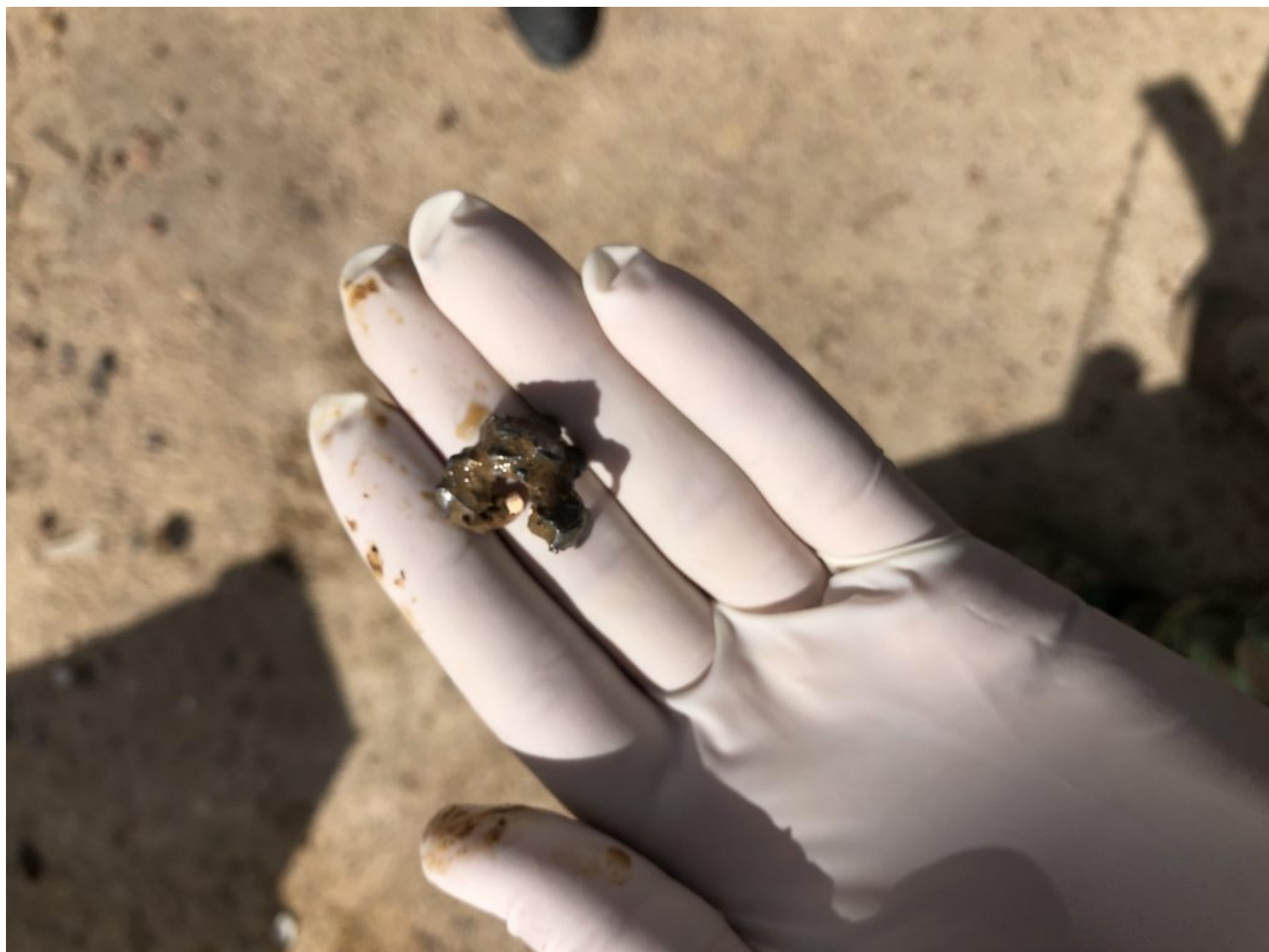
Figura 01: projtil do tipo Bonded recuperado de um bloco de argila.
